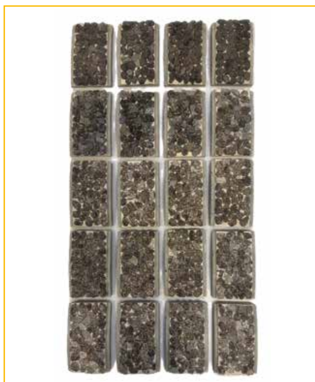
Fig. 5. I campioni sottoposti a prova di attrito radente
