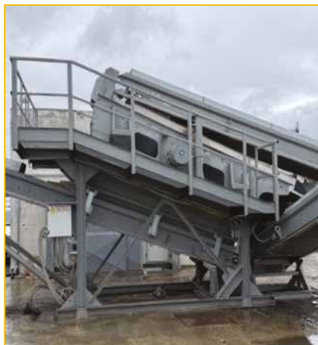
Fig. 3. Il vaglio vibrante flip-flow
