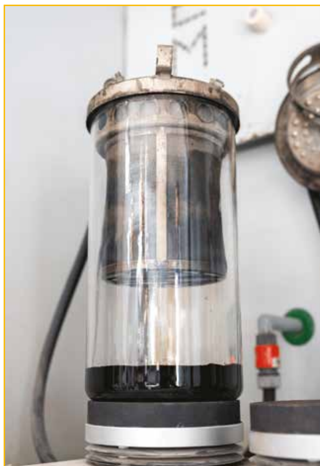
Fig. 4. Il campione di granulato sottoposto ad estrazione del legante
