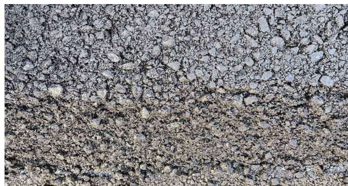
1. Stesa di conglomerato bituminoso ad elevato contenuto di granulato
