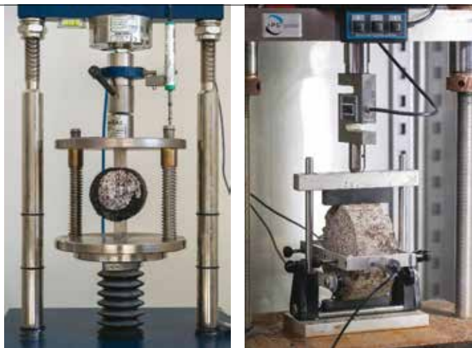
8A e 8B. Attrezzatura utilizzata per le prove di resistenza e di modulo a trazione indiretta
