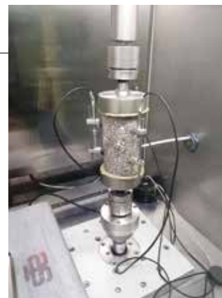
11. Configurazione in trazione/compressione per le prove di modulo complesso
