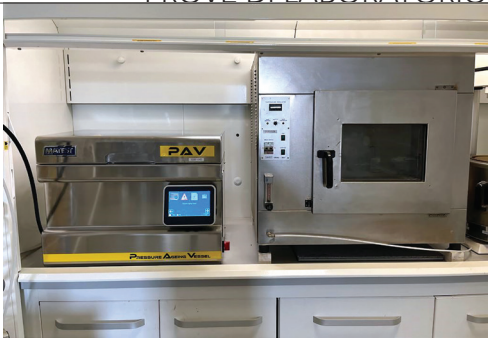
11. Il Pressure Ageing Vessel (PAV) e il Rolling Thin Film Oven Test (RTFOT)
