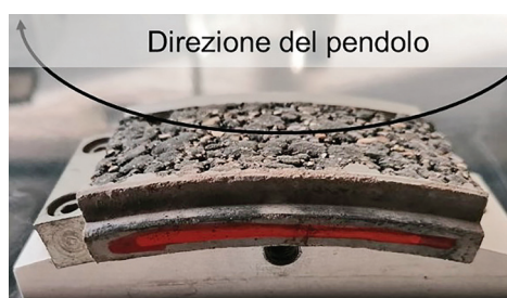
13. Il provino installato su pendolo con segno frontale
