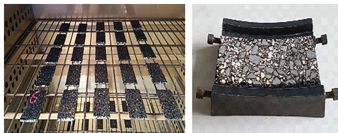
11A e 11B. Le fasi di riscaldamento dei provini in conglomerato bituminoso (11A) e di deformazione del provino per ottenere la forma ricurva (11B)
