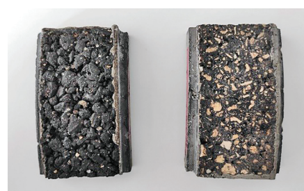
16. La condizione iniziale (a sinistra) e massima (spogliamento - a destra) del provino
