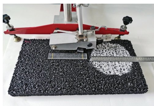
14A e 14B. La determinazione di aderenza su lastra in conglomerato bituminoso (14A) e su provino ricurvo (14B)
